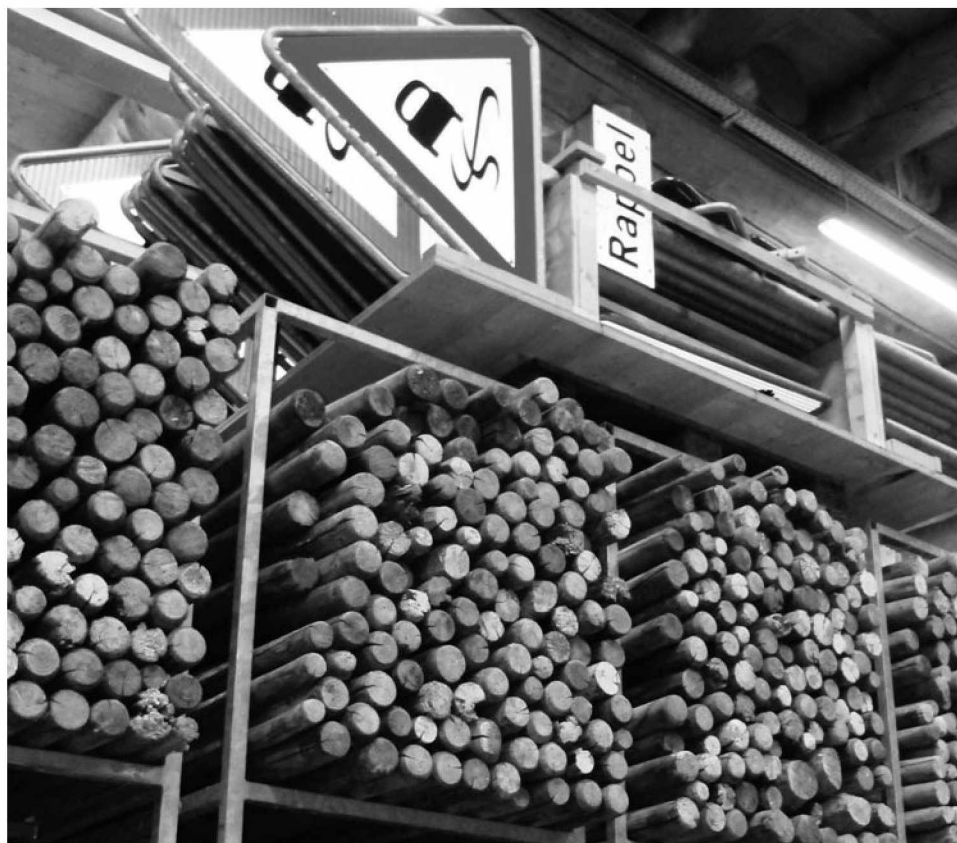
2'000 piquets pour cinq kilomètres de barrières à neige
