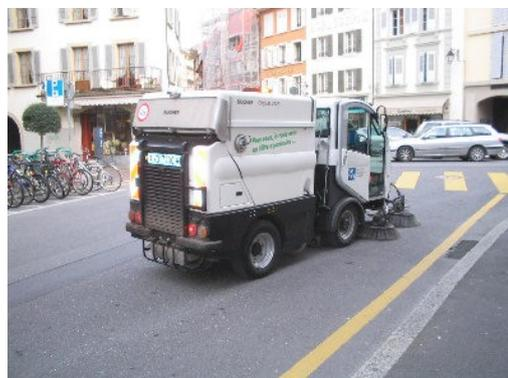
La nouvelle balayeuse laveuse effectue un travail efficace, propre et rapide. Elle est équipée d'un filtre à particules à régénération électrique. Elle est engagée environ 2'000 heures/an.
