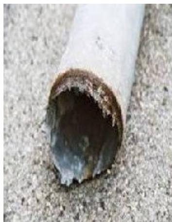
L'éclairage public fait l'objet d'une attention particulière. En 2006, il a été procédé à l'échange de certains luminaires, mâts et câbles (matériel présentant des risques de ruptures, corrosion selon photo). Dépenses :
